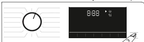
Si le niveau d'eau dans la machine est inapproprié lorsque vous appuyez sur le bouton **Marche/Pause**, le verrouillage de porte ne peut pas être désactivé et son icône reste active à l'écran.
