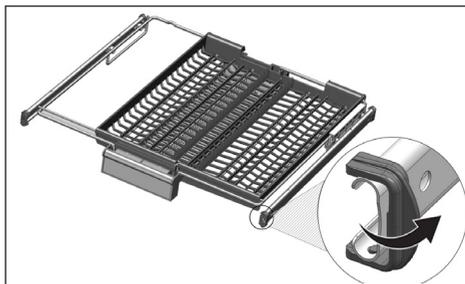
Lorsque le plateau central est en position basse, vous pouvez charger des objets longs et hauts tels que les tasses à café, les louches, etc. sur le plateau. Lorsque les plateaux latéraux reposent sur deux parois latérales, vous pouvez tirer la poignée pour permettre au plateau central de se soulever et de verrouiller le système.
