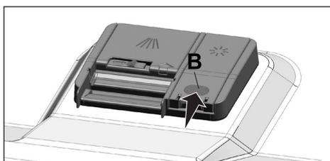
4. S'il y a des taches sur les couverts après le lavage, le niveau doit être augmenté et si vous observez une trace bleue après les avoir essuyés à la main, il doit être diminué. Il est réglé sur le niveau 3 comme réglage d'usine.
