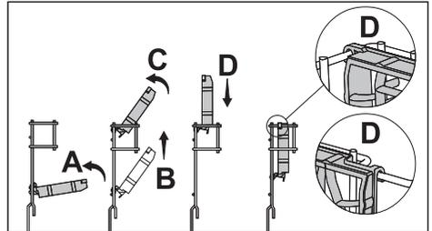
**i** In umgekehrter Reihenfolge lassen sich die Ablagen öffnen.
