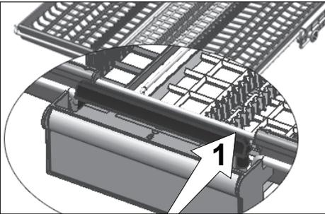
In Modellen mit flexibler Besteckschublade können Sie die mittlere Ablage des Korbs durch Drücken des Hebels (1) am Griff auf die unterste Position einstellen wie in Bild B abgebildet. Damit wird das System freigegeben. Dadurch können die rechten und linken Ablagen als bewegliche Teile genutzt werden wie in Bild C und D abgebildet.
