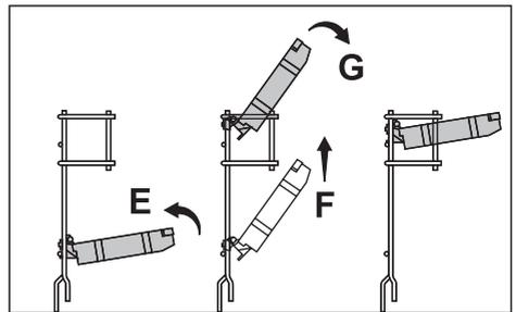
**i** Die Ablagen können wie erforderlich durch Verschieben in eine niedrigere oder höhere Position oder durch Schließen zur Schaffung von mehr Platz im unteren Korb genutzt werden.
