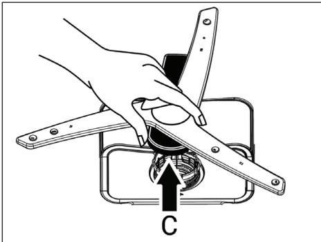
Zum Ausbauen und Reinigen der unteren Sprüharmbaugruppe halten Sie sie an den in der Abbildung gezeigten Punkte (C) mit einer Hand fest und ziehen Sie sie nach
