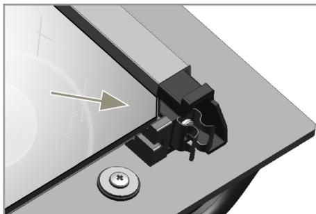
Der erste Schritt bei der Neugruppierung der Tür besteht darin, das zweite und dritte Glas wieder einzusetzen (2, 3). Platzieren Sie, wie in der Abbildung gezeigt die abgechränkte Kante des Glases so, dass sie auf die abgechränkte Kante des Plastikschlitzes trifft.
